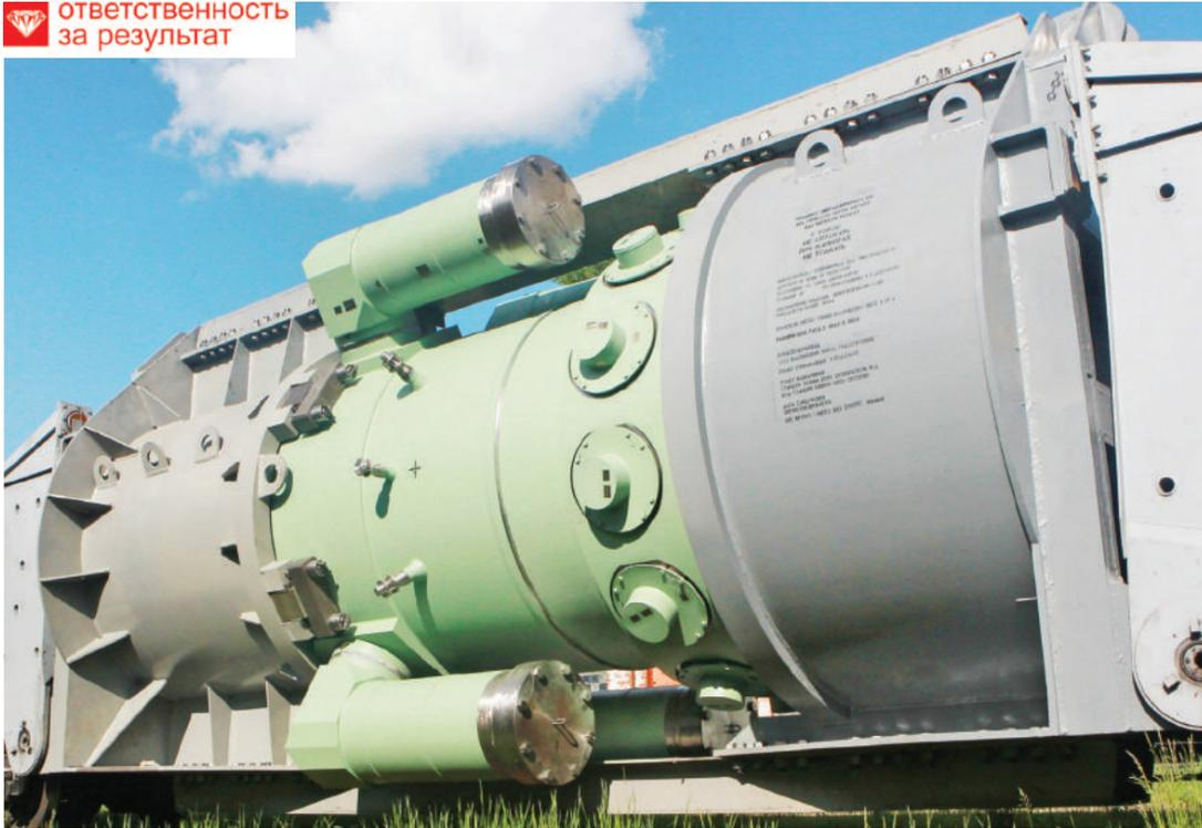
«ЗиО-Подольск» изготовил основное оборудование самой современной в мире судовой реакторной установки «РИТМ-200» для головного универсального атомного ледокола ЛК-60Я проекта 22220 «Арктика».
